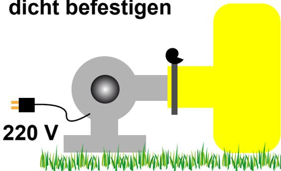
Dauergebläsemotor an den Strom anstecken, Steckverbindungen vor Nässe schützen, Motor abdecken
